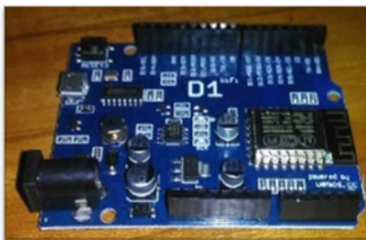
Figure 3. Wemos D1 microcontroller
